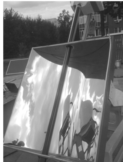
Рис. 4. Общий вид параболоцилиндрического концентратора с приемником на базе тепловой трубы в вакуумной теплоизоляции
