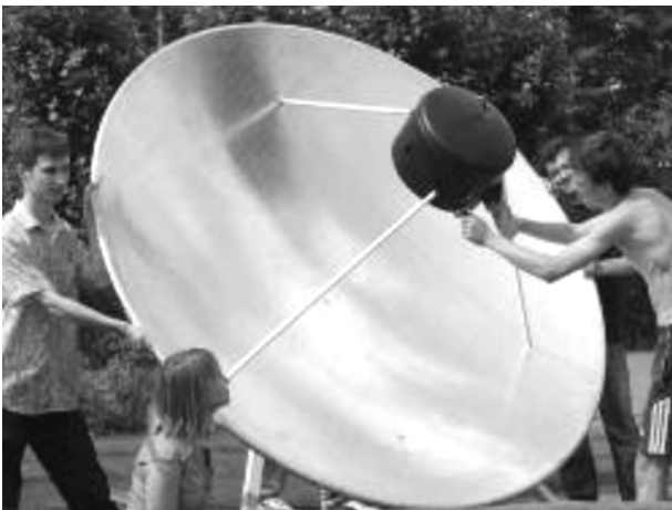
Рис. 2. Студенты С. Теребей, А. Паздников производят настройку фокусного расстояния концентратора под руководством аспиранта С. Коржавина Fig. 2. Students S. Terebey and A. Puzdnikov align the focal distance of a concentrator under the direction of postgraduate student S. Korzhavin
