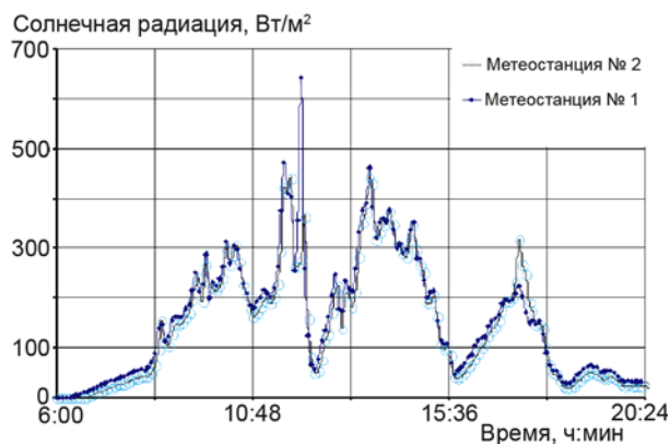
Рис. 5. Сопоставление результатов суточного измерения интенсивности солнечной радиации метеостанциями юго-восточной (№ 1) и южной (№ 2) ориентации Fig. 5. The comparison of the daily measurements of the solar radiation intensity of weather stations of south-eastern (No. 1) and southern (No. 2) orientation
